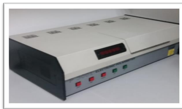
Slika 21. Polarimetar, uređaj za očitavanje škroba (Izvor: vlastita fotografija)
