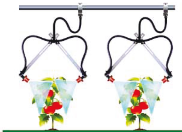
Slika 2. Shematski prikaz rada tzv. rednog nosača mlaznica
