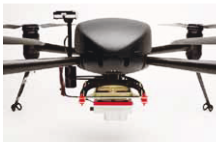
Slika 7. RTK senzor ugrađen na bespilotnoj letjelici
