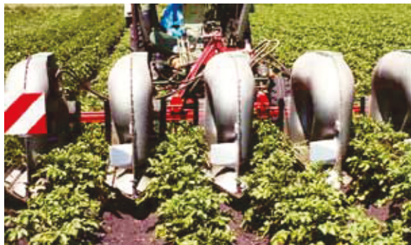
Slika 3. Uređaj za sakupljanje zlatica
