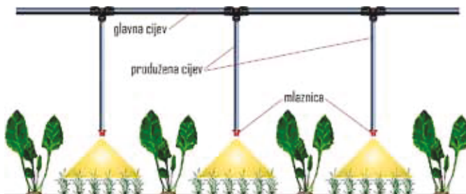
Slika 1. Shematski prikaz rada mlaznica na produženim cijevima
