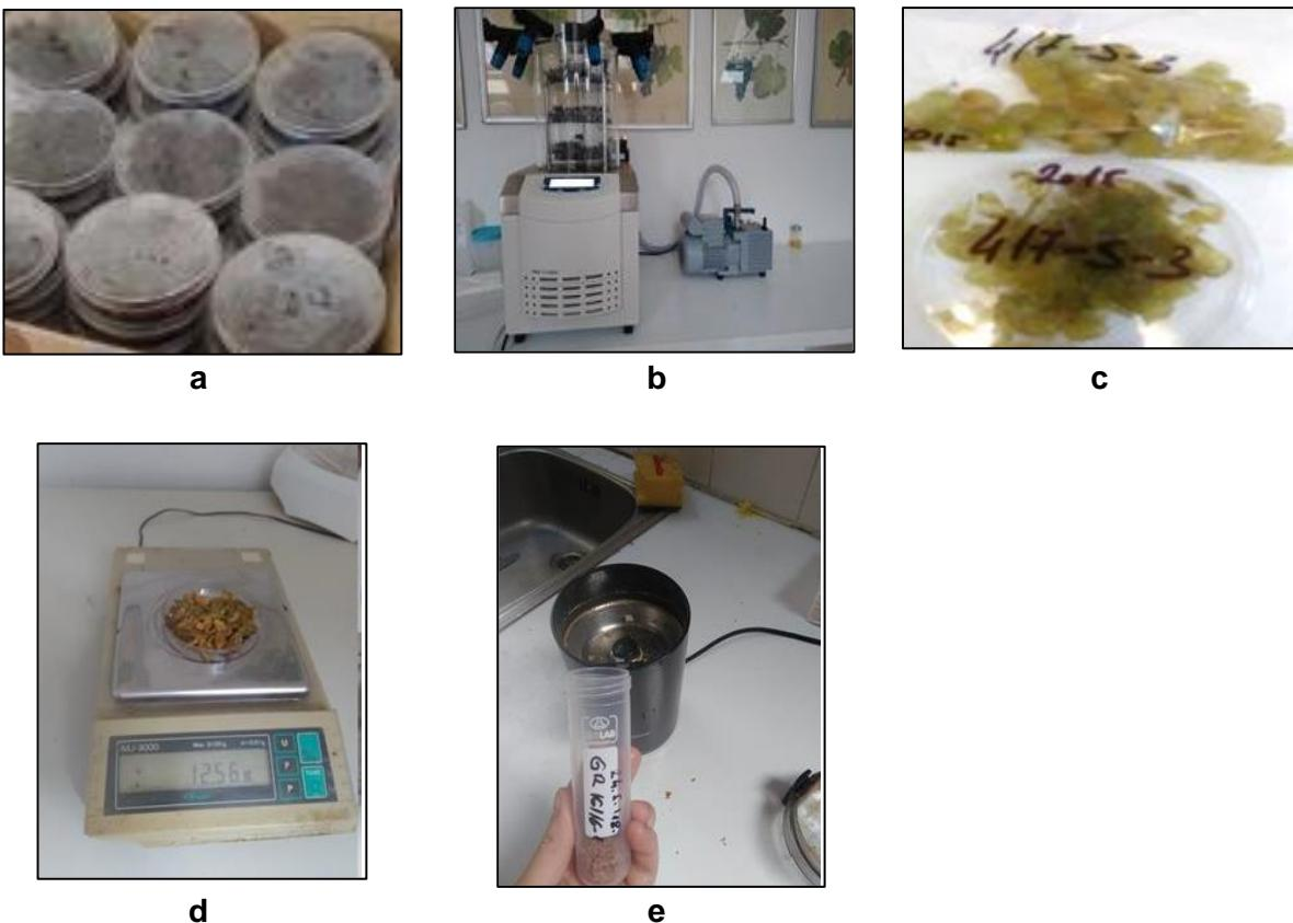
Slika 9. Priprema uzorka za ekstrakciju hlapljivih organskih spojeva (a- odvojene kožice bobica, b – liofilizacija kožica, c, d – kožice nakon liofilizacije i e – homogenizacija liofiliziranih kožica)
