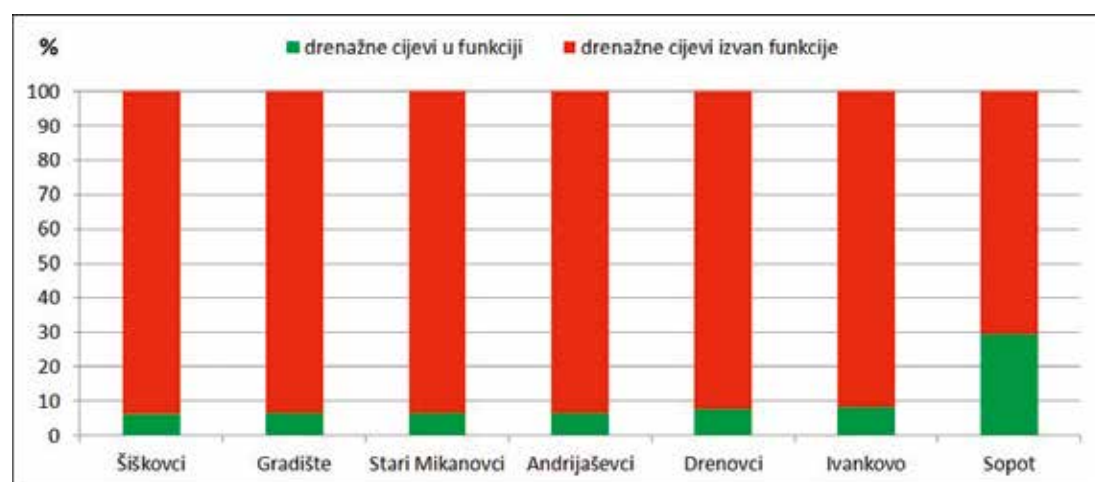
Slika 11: Pregled devastacije cijevne drenaže po kontrolnim cjelinama u Vukovarsko-srijemskoj županiji (Izvor: „Drenaža zemljišta Hrvatske“, Petošić, 2021.).
