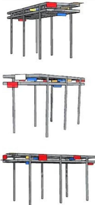
Model 1 predstavlja pergolu sastavljenu od dva uzdužna pravokutna elementa postavljenih jedan ispod drugoga na stupovima. Koncipirana je kao fiksirani element na kojem su osmišljeno poslagani L oblici lameniranog stakla u boji. Promišljenim slaganjem stakala u boji postiže se cilj dobivanja osnovnih, primarnih, sekundarnih, tercijarnih te akromatskih odnosno neboja.
