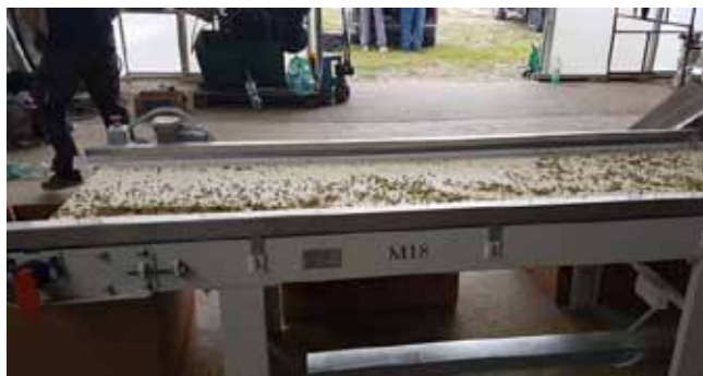
Slika 9. Revizijski transporter Figure 9. Revisory conveyor Izvor/Source: Herbas
