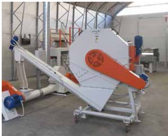
Slika 10. Rezačica biljne mase Figure 10. Herbs cutter Izvor/Source: Herbas
