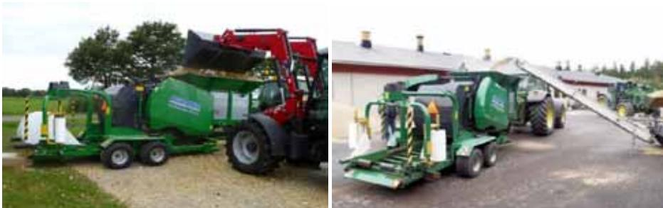
**Slika 1.** Preša za valjkaste bale s utovarnim spremnikom i omotačem bala Agronic MultiBaler 85-90 u stacionarnom načinu rada
