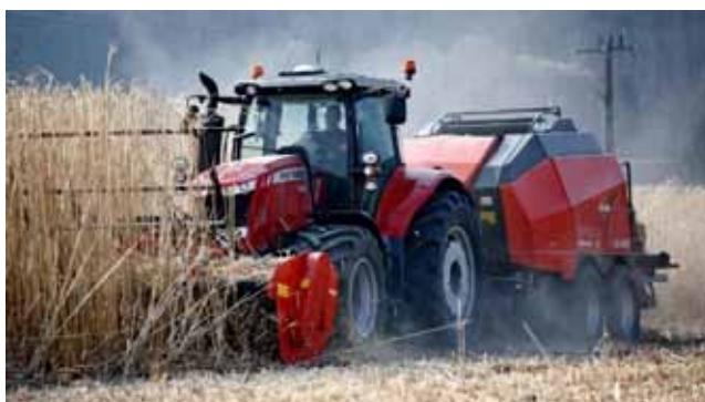
**Slika 8.** Žetva i prešanje u jednom prohodu (*Kuhn WS 320*, preša za velike četvrtaste bale *Kuhn LSB 1290* i traktor *Massey Ferguson 7626*)
