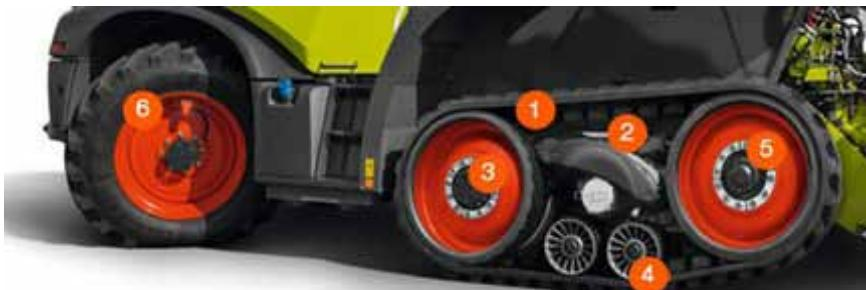
Dijelovi sustava *TERRA TRAC* (Claas): 1) Radna traka (gusjenica), širina: 635 mm, 735 mm ili 890 mm, 2) Sustav zatezanja ovjesa i trake, 3) Pogonski kotač, 4) Potporni kolut, 5) Radni kotač i 6) Regulator pritiska gume, upravljačka osovina.
