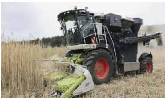
**Slika 4.** Samokretni stroj (kombajn) *Metitron 560* za ubiranje i peletiranje biomase
