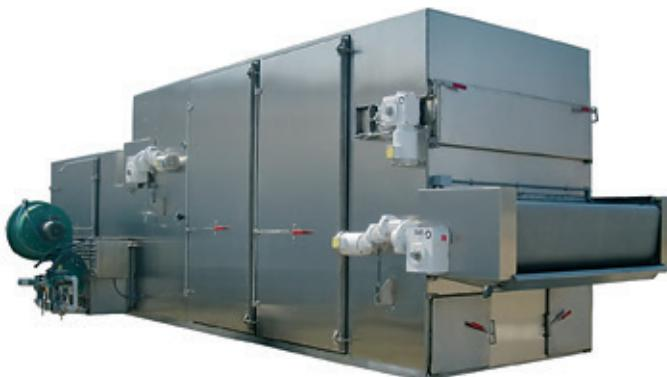
**Slika 18.** Niskotemperaturna kontinuirana sušara
