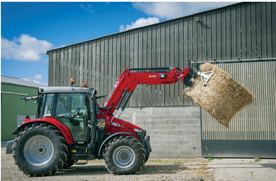
**Slike 18.** Prednji traktorski utovarivač (Izvor: <https://www.austrodiesel.at/hr/poduzece/news/detail/modeli-serije-mf-5700-sl-idealni-su-traktori-i-za-najteze-primjene-utovarivaca/>)
