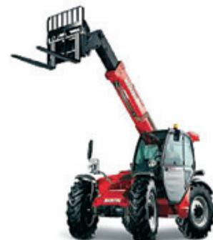
**Slika 8.** Samohodni teleskopski utovarivač
