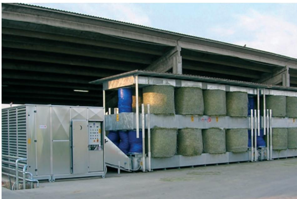
**Slika 20.** Modularna sušara s metalnim kanalima
