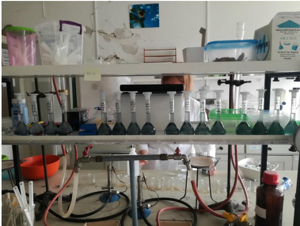
Slika 3.4.1. Uzorci pripremljeni za mjerenje apsorbancije
