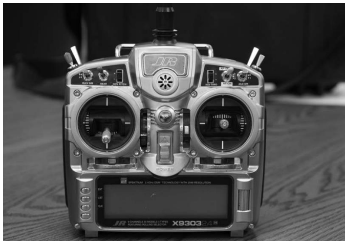
Сликa 6.1. Рyчнa кoнзoлa кoја мoжe бити кoристeнa кoд upрaвљaњa UAV-ом.
