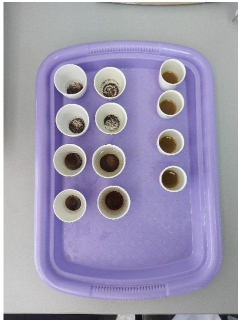
Slika 3.2.1. Određivanje mehaničkog sastava tla; frakcije krupnog i sitnog pijeska u porculanskim lončićima
