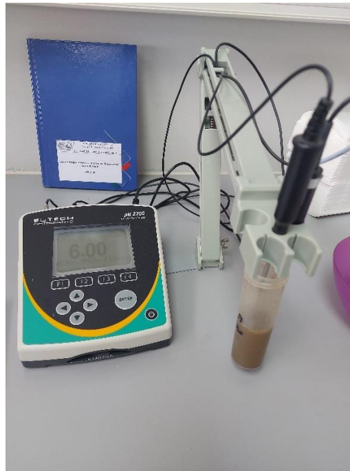
Slika 3.2.3. Postupak određivanja reakcije tla pH-metrom cilindri s prahom i glinom Foto: Jana Krkalo, 2023
