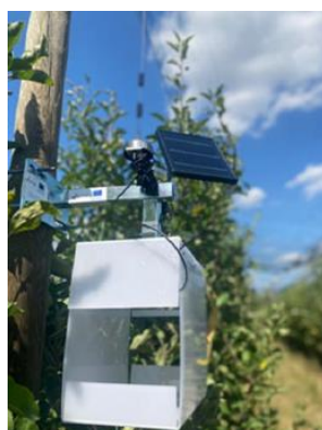
Slika 2.5.2. Razvijeni prototip pametne lovke za praćenje štetnika jabuke.
