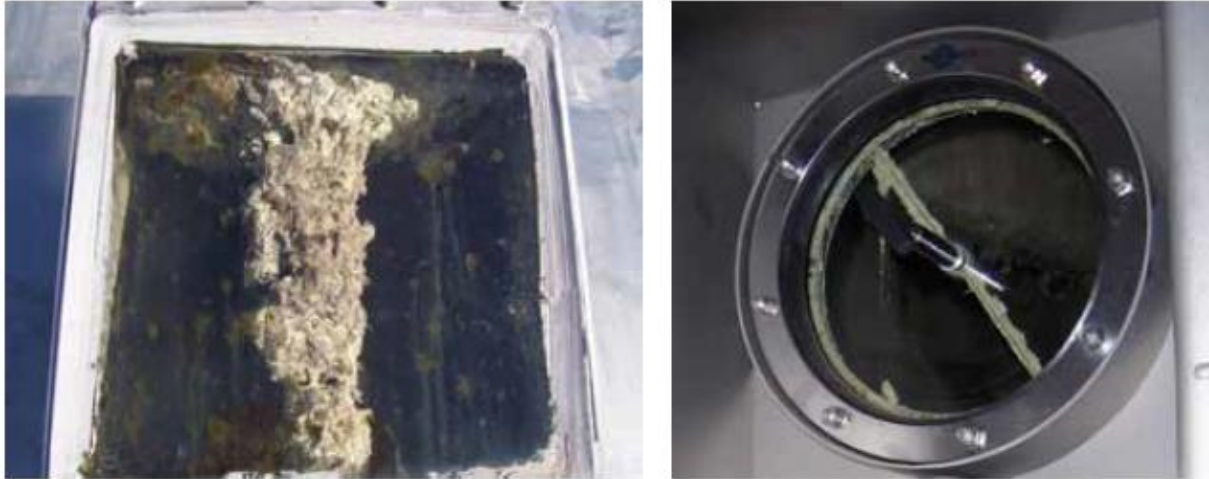
Slika 6. Elementarni sumpor, rezultat biološke desumporizacije
