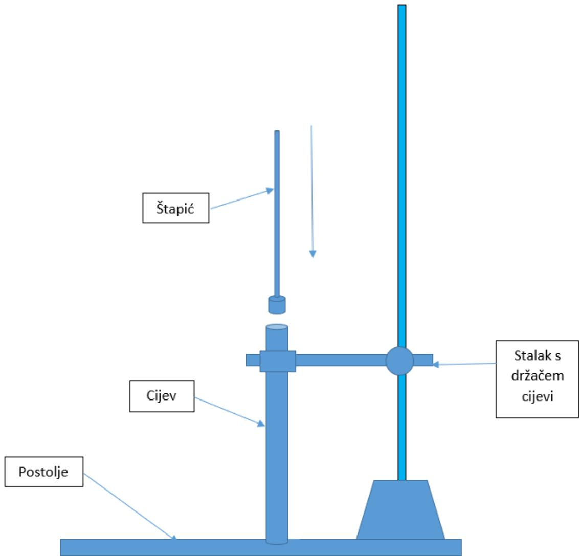
Slika 2.1. Dijelovi opreme pomoću koje su se zrna kukuruza izlagala udarcima
