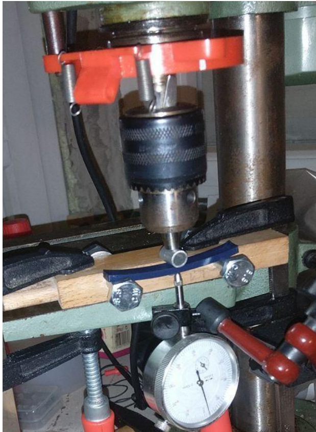
Slika 11.9. Ispitivanje uzorka prema standardu ISO 178 Izvor: Vlastita fotografija
