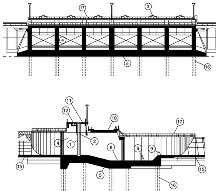
Slika 2.24. Elementi poprečnog presjeka ustave: 1 – pločasti zatvarač; 2 – utori zatvarača; 3 – uređaj za podizanje zatvarača; 4 – pregradni zidovi; 5 – temeljna ploča; 6 – ulazni dio; 7 – izlazni dio; 8 – slapište; 9 – disipatori energije; 10 – most; 11 – poslužni mostić; 12 – kanal za energetske kablove; 13 – krilni zidovi; 14 – cesta; 15 – obloga dna i pokosa ulaznog i izlaznog dijela; 16 – piloti i 17 – ograda (izvor: Cerić i sur. 2022.)
