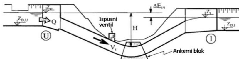
Slika 2.23. Uzdužni presjek sifona (Izvor: Suljić, pristupljeno 12.07.2023.: <http://www.nedim-suljic.mojweb.ba/file/5-objekti-na-dovodima/46>)
