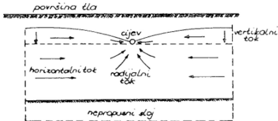
Slika 2.10. Vertikalni, horizontalni i radijali tok vode (izvor: Tomić 1987.)
