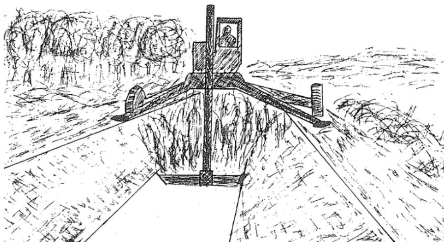
Slika 2.18. Bager kanaločistač (izvor. Marin A., 1989.)
