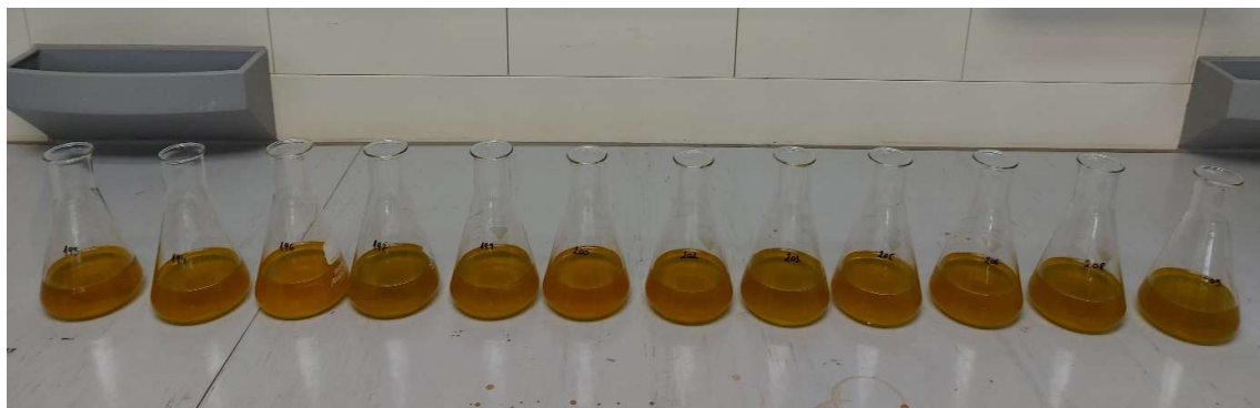
Slika 3.3.6. Uzorci sa dodanim kalijevim bikromatom ( K_2Cr_2O_7 ) (foto: Nikolina Jurković Balog, 2023.)
