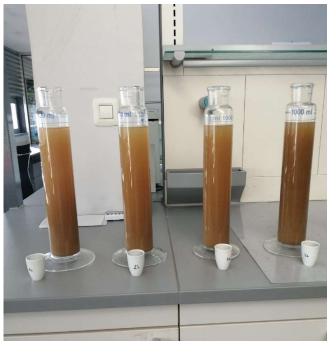
3.3.4. Cilindri za sedimentaciju pripremljeni za pipetiranje praša i gline (foto: Adelisa Smajć, 2023.)
