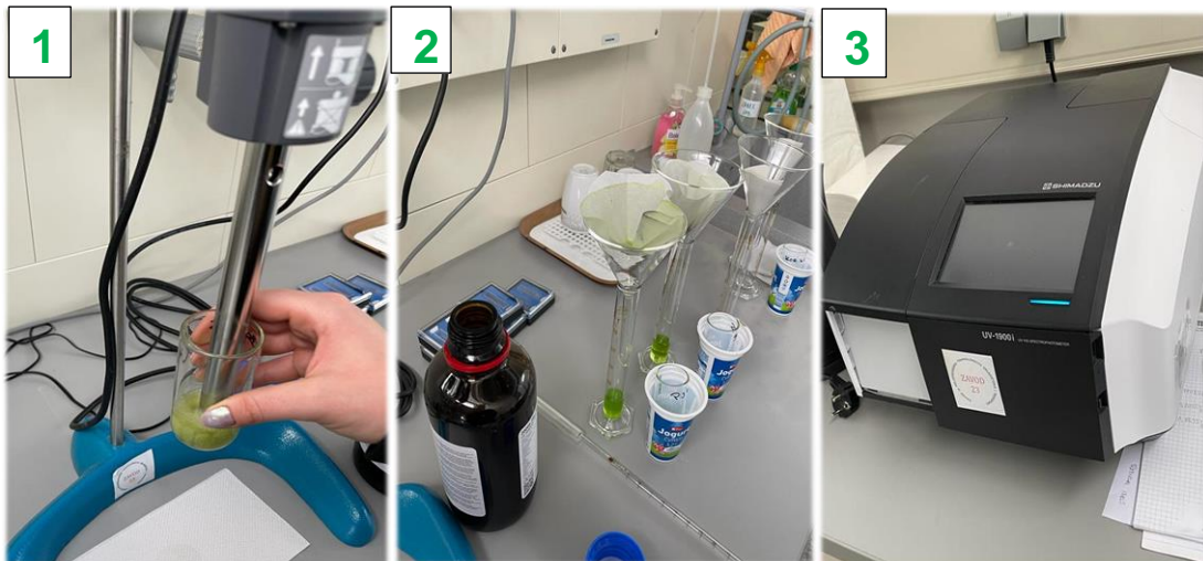
Slika 3.2.1.2. Prikaz postupka određivanja klorofila – 1. uzorak s acetonom koji se homogenizira, 2. filtracija uzorka, 3. spektrofotometar (foto: M. Vrbanić)
