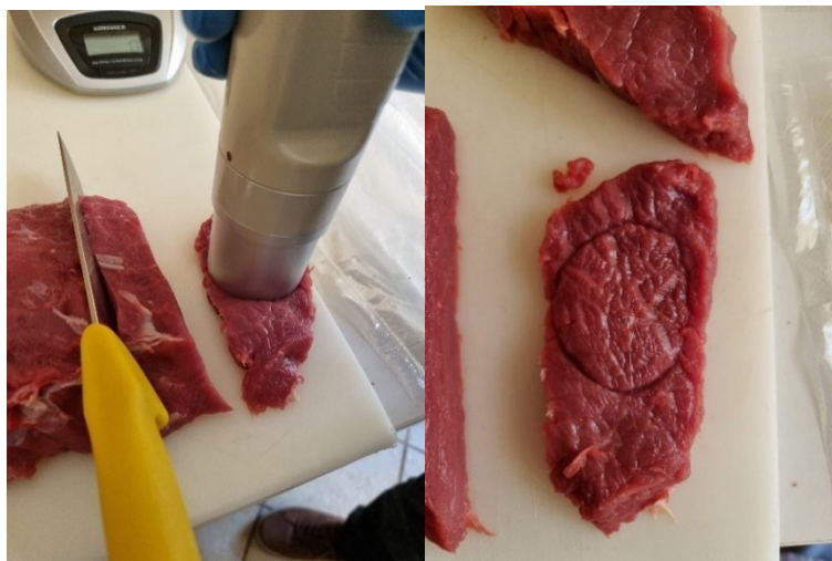
Slika 3.4.2. Mjerenje boje mesa korištenjem prijenosnog kromametra
