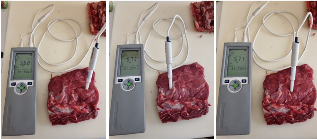
Slika 3.4.1. Mjerenje pH vrijednosti mesa na tri pozicije
