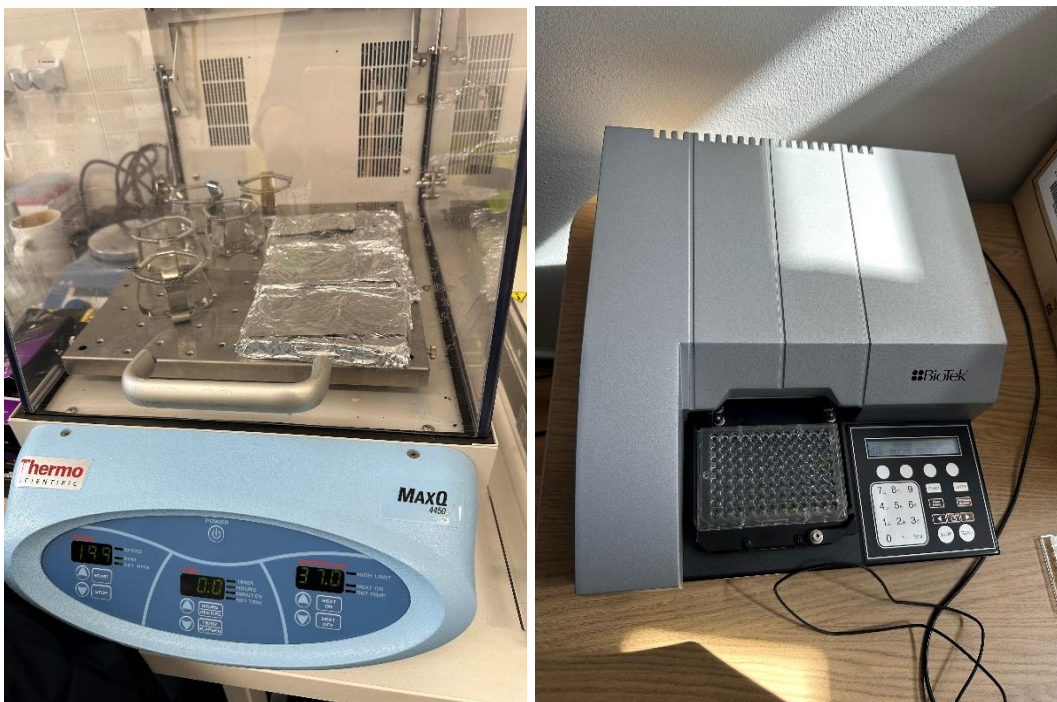
Slika 3.6.2.2. Pločice na inkubaciji na 37 °C (lijevo) i spektrofotometar EL 800 (Biotek, SAD) korišten za očitavanje rezultata (desno)
