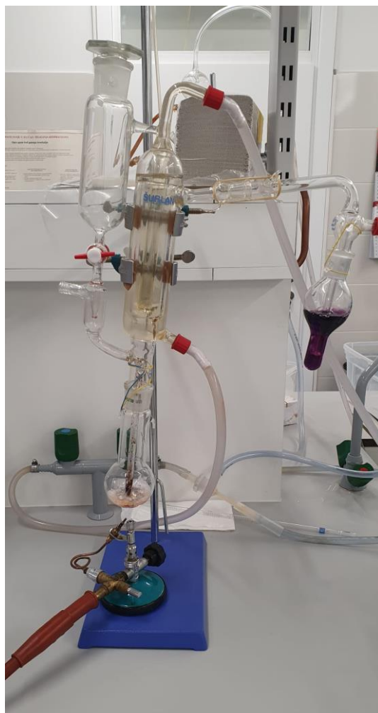
Slika 8. Aparatura potrebna za određivanje sumporovog dioksida u vinu metodom po Paulu-u. (Izvor: Budžaki, 2023.)
