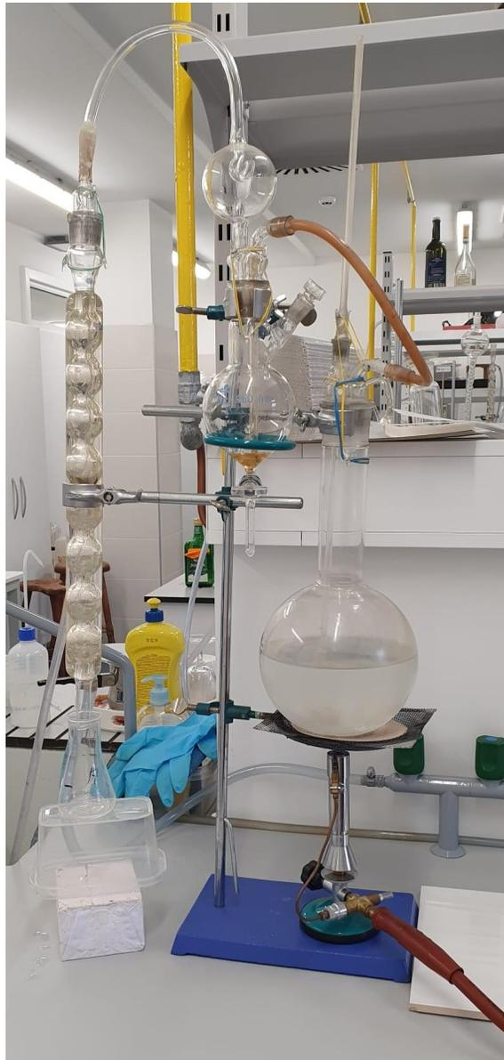
Slika 7. Postupak dobivanja destilata potrebnog za određivanje hlapljive kiselosti
