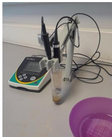
Slika 3.3.1. Postupak određivanja reakcije tla pH metrom
