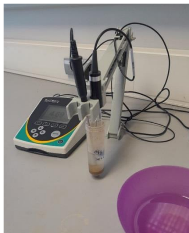
Slika 3.3.1. Postupak određivanja reakcije tla pH metrom
