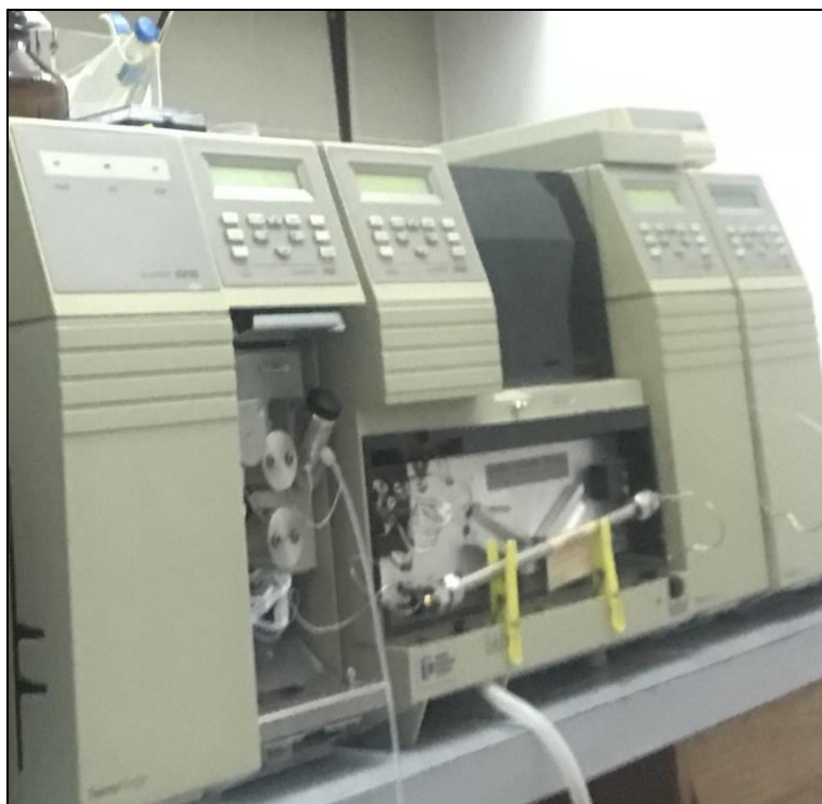
Slika 3.3.3. Tekućinska kromatografija visoke djelotvornosti ( engl. HPLC, High Performance Liquid Chromatography)
