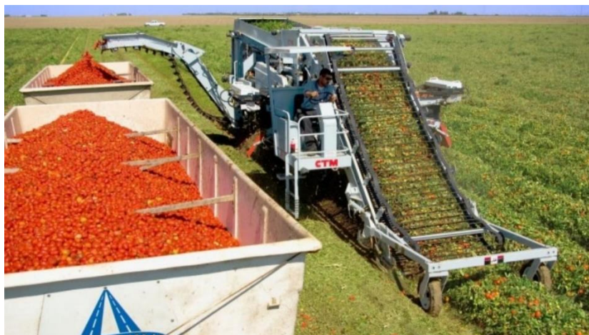
Slika 11. Mehanizirana berba rajčice za preradu
