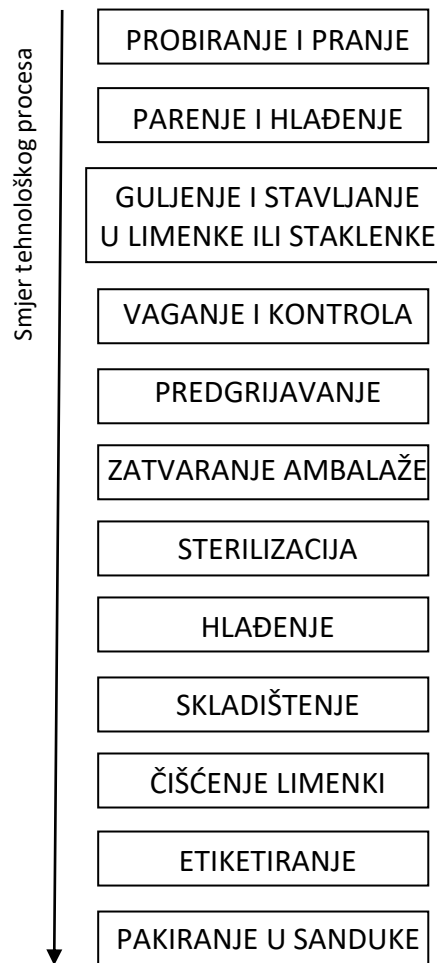
Slika 16. Prikaz tehnološkog procesa izrade pelata
