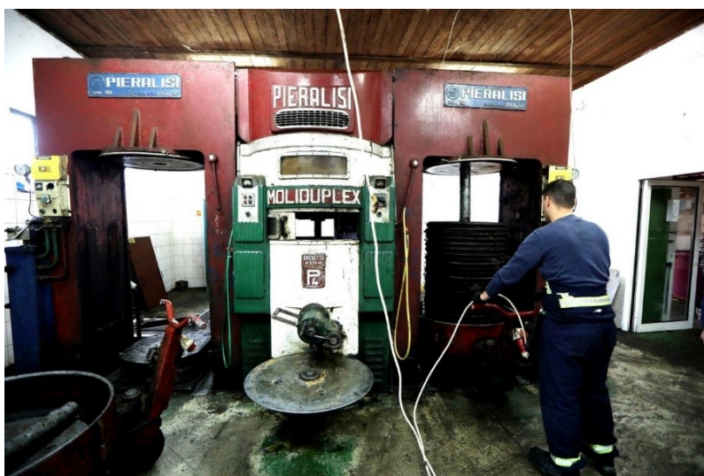
Slika 2.4. Prerada ulja prešanjem u Primoštenu (trofazni način)
