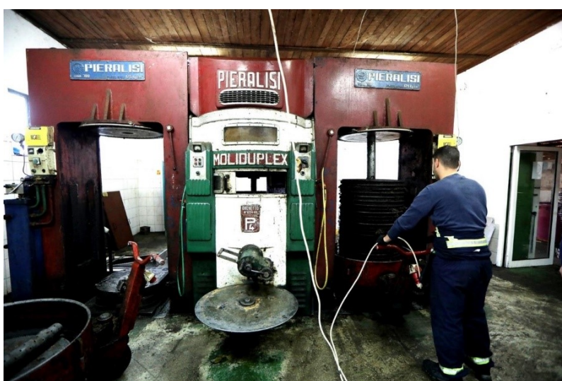
Slika 2.4. Prerada ulja prešanjem u Primoštenu (trofazni način)
