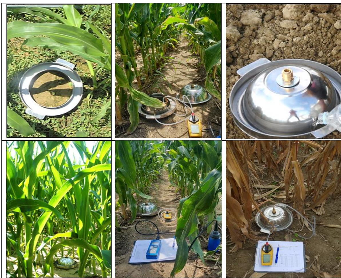
Slika 2.5.1. Mjerenje koncentracije ugljikovog dioksida iz tla
