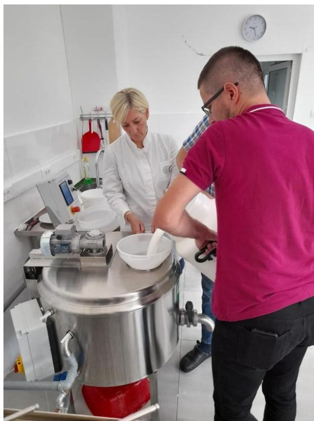
**Slika 3.1.1.** Odvajanje mehaničkih nečistoća iz kozjeg mlijeka
