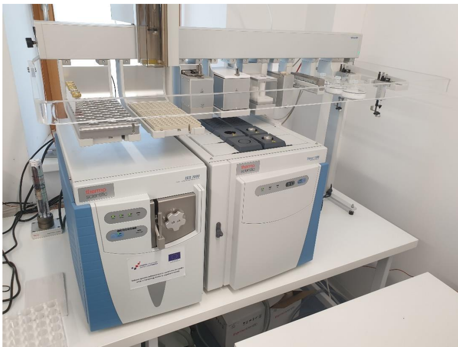
Slika 3.3. Uređaji Thermo Scientific Trace 1300 i Thermo Scientific ISQ 7000 korišteni za analizu hlapljivih aromatskih spojeva (Izvor: vlastita izrada autora, 2022.)
