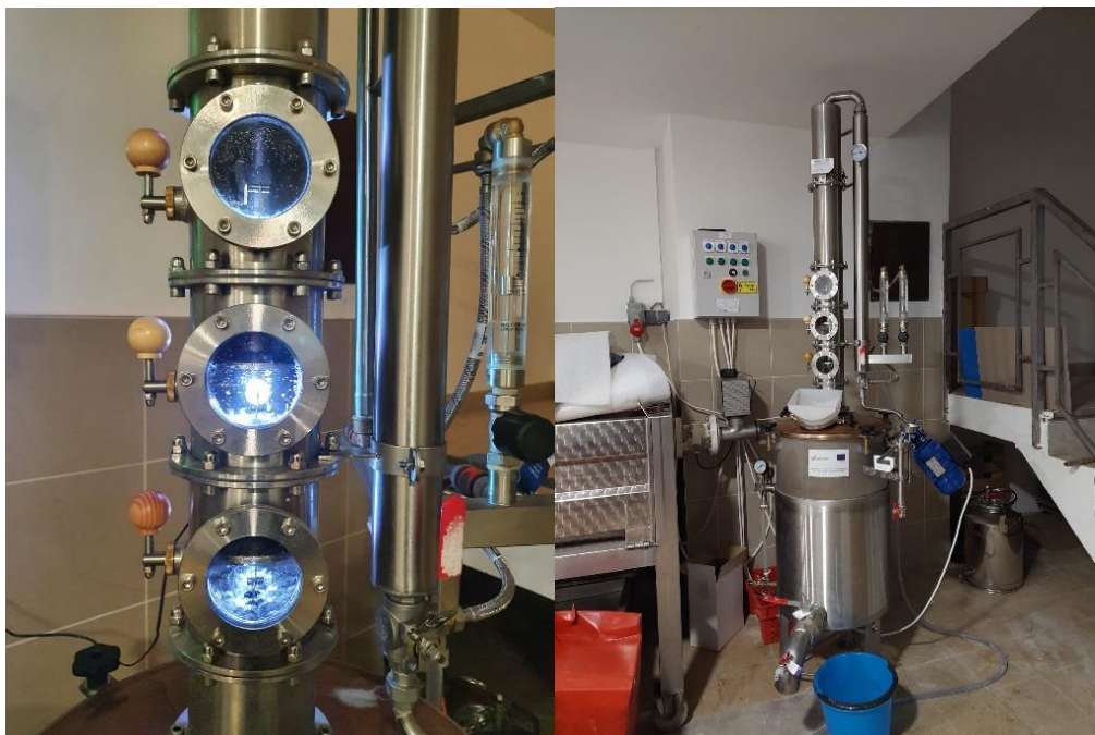
Slika 3.8. i 3.9. Složeni destilacijski uređaj
