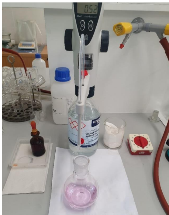
Slika 3.12. Metoda određivanja ukupne kiselosti destilata
