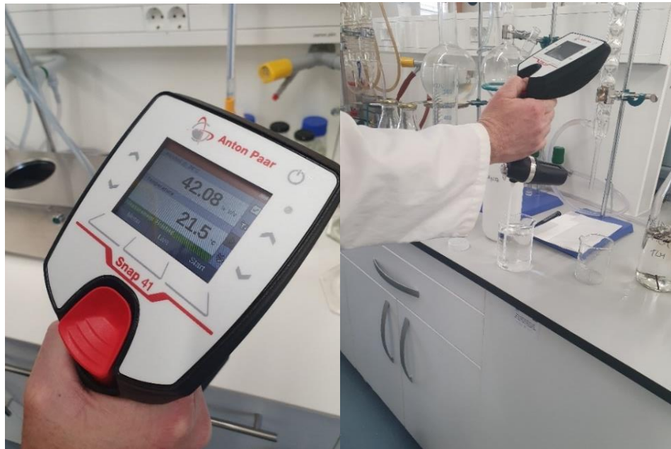
Slika 3.10. i 3.11. Mjerenje alkoholne jakosti denzitometrom
