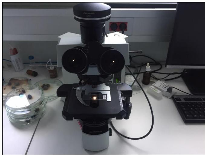
Slika 38. Binokularni optički mikroskop Olympus BX 51
