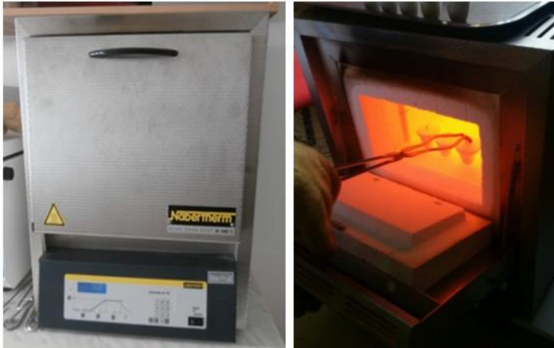
Slika 19. Određivanje sadržaja koksa u mufolnoj peći
