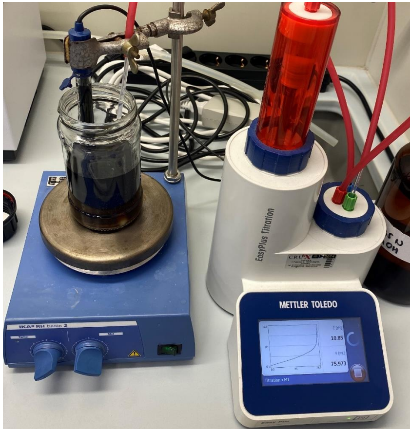
Slika 39. Mjerenje pH kako bi se utvrdila ekvivalentna točka
