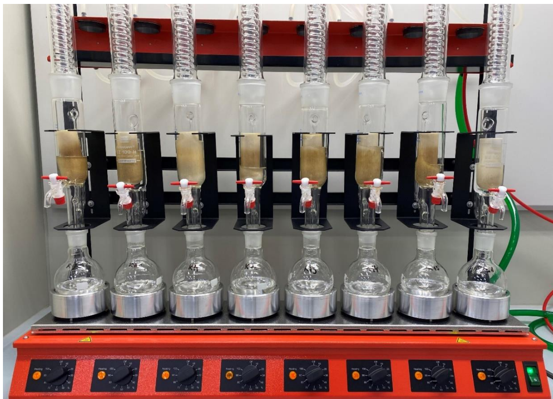
Slika 23. Ekstrakcija na Soxhlet uređaju
