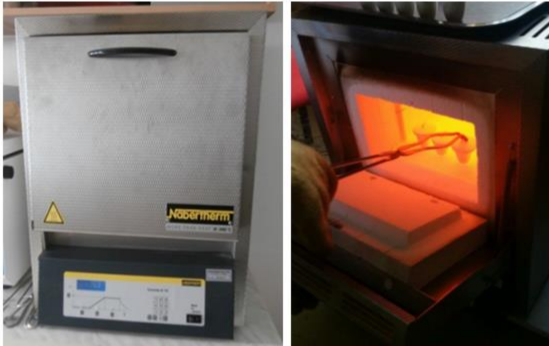
Slika 19. Određivanje sadržaja koksa u mufolnoj peći
