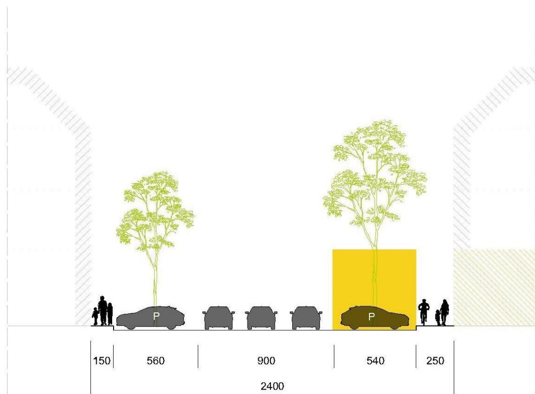
Slika 9.12. Poprečni presjek Žerjavićeve ulice (ul. br. 24)
