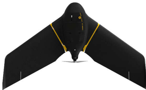
Slika 2. Bespilotna letjelica s fiksnim krilima (izvor: www.sensefly.com )
