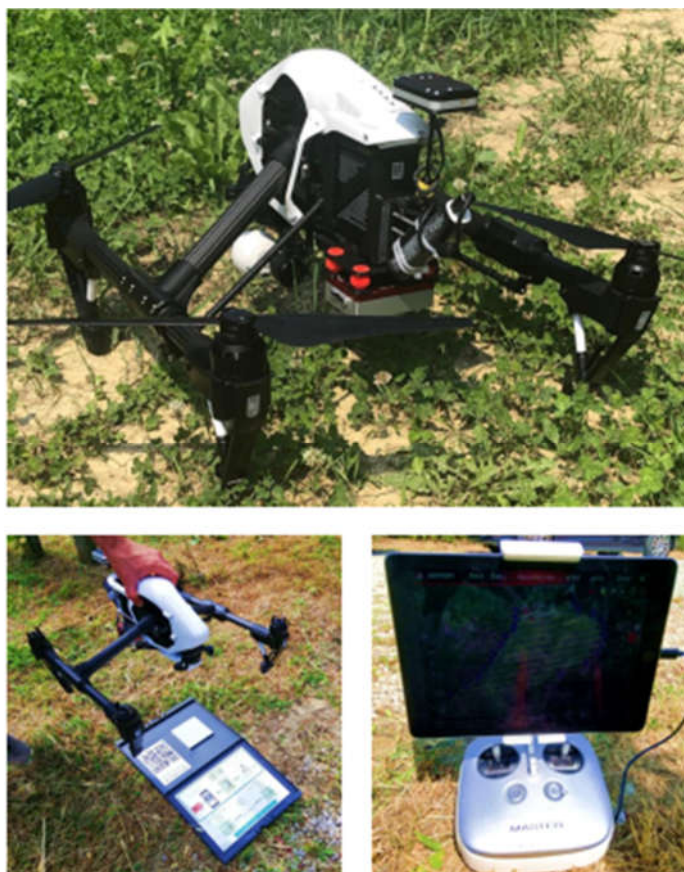
Slika 11. Bespilotna letjelica DJI Inspire 1 Pro opremljena Micasense RedEdge.MX™ multispektralnim senzorom
