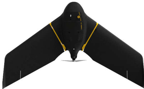
Slika 2. Bespilotna letjelica s fiksnim krilima (izvor: www.sensefly.com )
