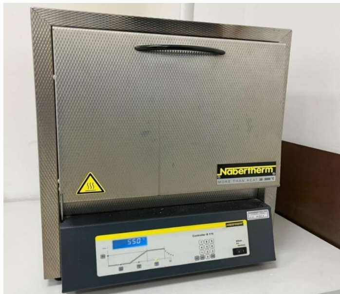
Slika 12. Mufolna peć Nabertherm B170 (izvor: vlastiti izvor)
