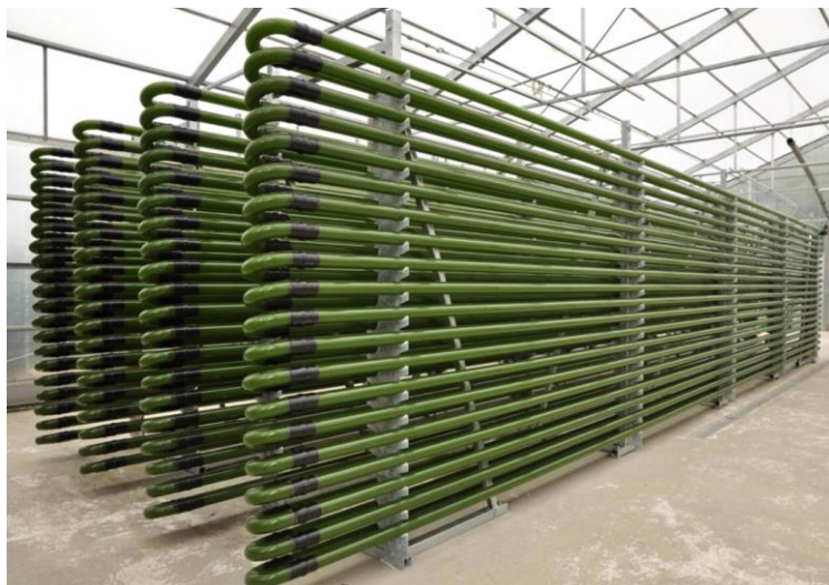
Slika 2.2.1.1. Zatvoreni sustav uzgoja - cjevasti fotobioreaktor
