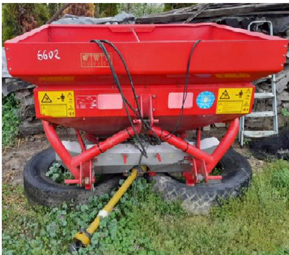
Slika 3.6. Raspodjeljivač mineralnog gnojiva Kverneland Exacta EL
