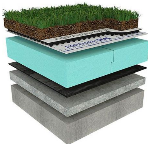
Slika 10. Shematski prikaz sub-intenzivnog krovnog vrta
