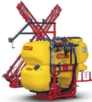
Slika 18. Nošena i samohodna prskalica (Izvor: www.messis.hr ; www.agroklub.com )
