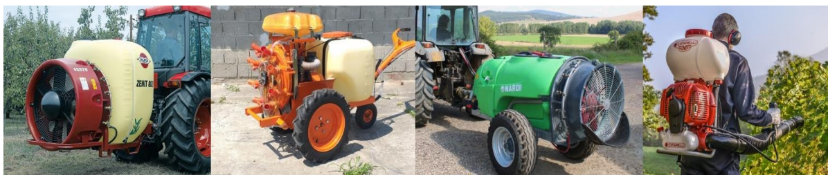
Slika 17. Nošeni, samohodni, vučeni, ručno vučeni (leđni) orošivači (Izvor: www.findri.hr ; www.briliant.hr ; www.agroopskrba-matej.hr )
