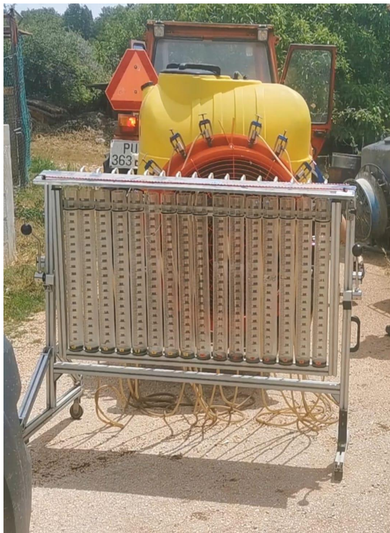
Slika 6. Ispitni uređaj za mjerenje protoka mlaznica orošivača s menzurama (Autor: Ostojić, L.)
