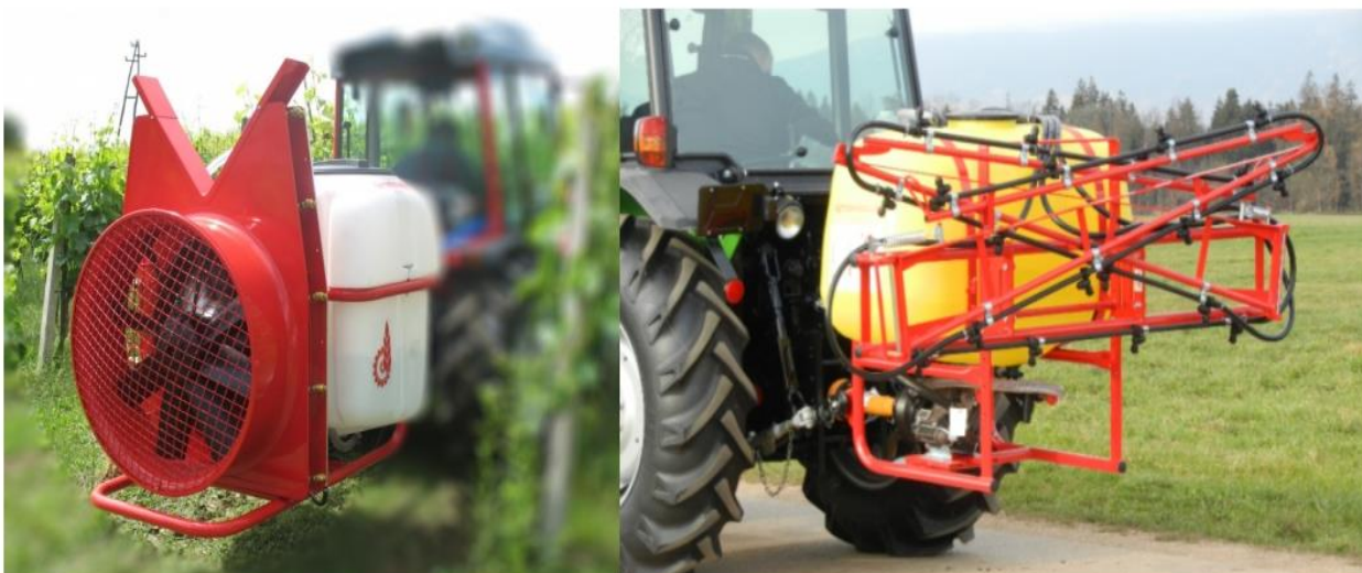
Slika 20. Agromehnika AGP 200 orošivač i Agromehnika AGS 200 prskalica (Izvor: www.agromehanika.eu )
