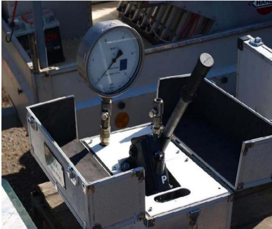
Slika 9. Uređaj za mjerenje ispravnosti rada manometra (Izvor: www.savjetodavna.hr )
