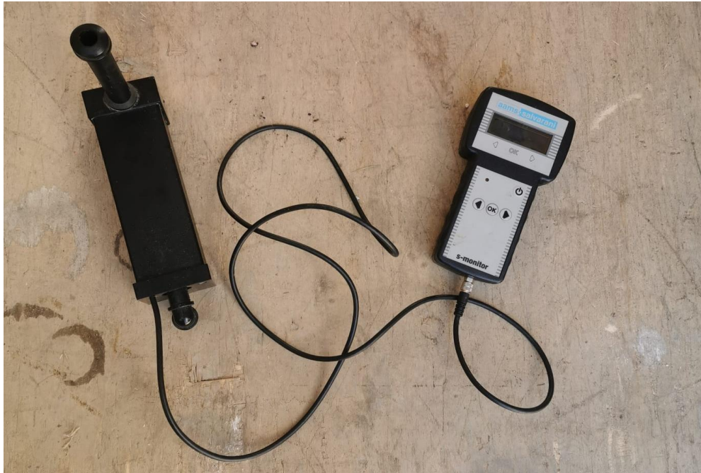
Slika 7. Ispitni uređaj za pojedinačno mjerenje protoka mlaznica (Autor: Ostojić, L.)
