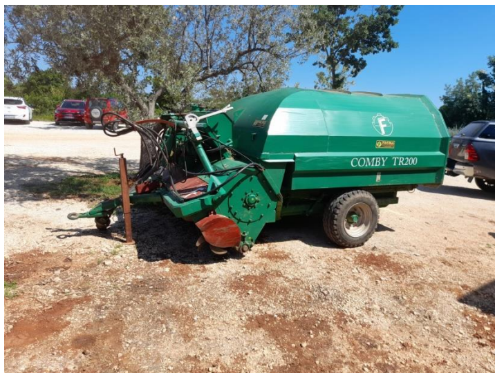
Slika 21: Sakupljač/usitnjivač za orezanu biomasu Comby TR200 (Izvor: vlastiti izvor)
