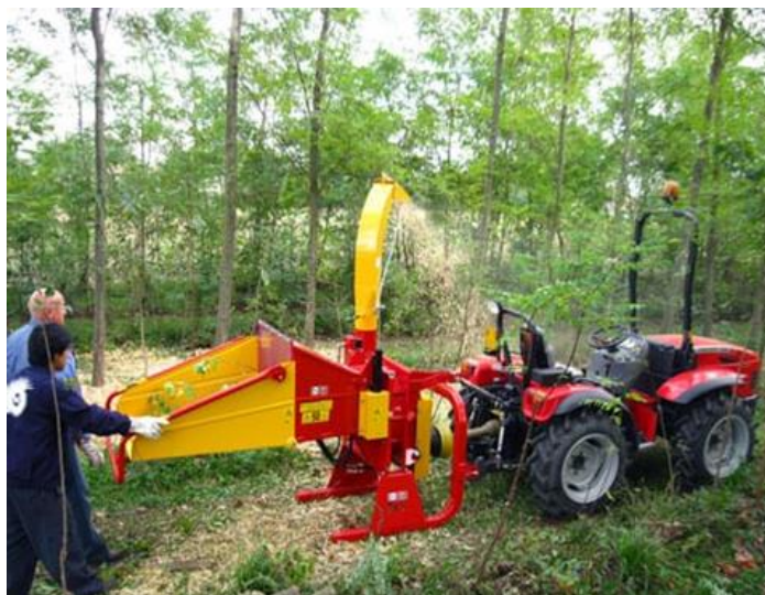
Slika 22: Stroj za usitnjavanje biljnih ostataka – model CPT 130 (Izvor: https://www.mesis.hr/ )
