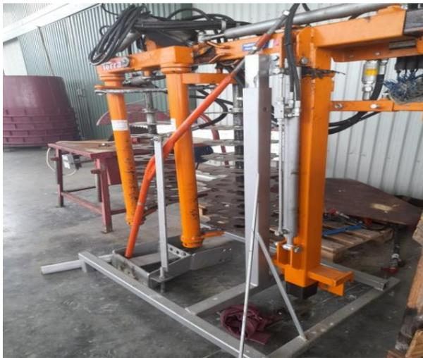
Slika 7: Uređaj za strojnu rezidbu vinograda
