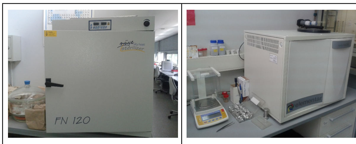
Slika 2.9. Sušionik i Vario, Macro CHNS analizator
