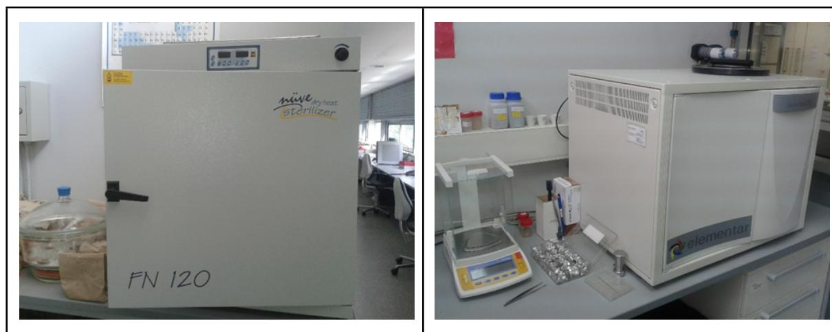
Slika 2.9. Sušionik i Vario, Macro CHNS analizator
