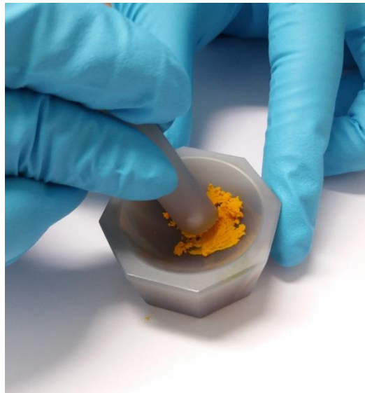
Slika 3.2.3. Priprema pčelinje peludi za spektralnu analizu (homogenizacija uzorka pčelinje peludi pomoću tarionika)
