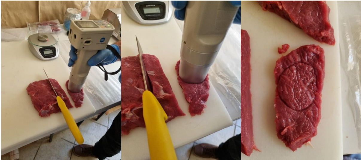
Slika 3.2.2. Mjerenje boje mesa korištenjem prijenosnog kromametra Minolta CR-410
