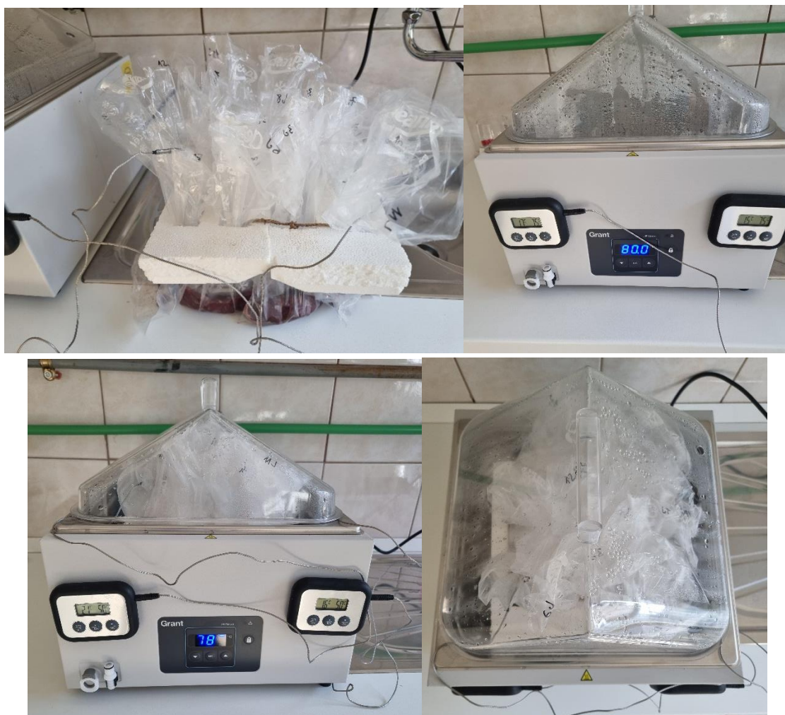
Slika 3.3.1. Postupak određivanja kala kuhanja uzoraka mesa
